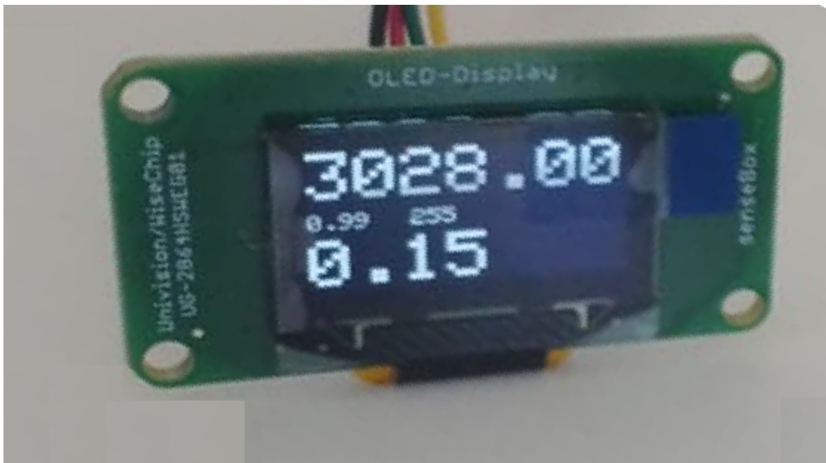
Abbildung 2.4: 1. Zeile: AINVAL (Summe mehrerer Spannungsmessungen) 2. Zeile links: alpha (Gewichtung von filtOut) 2. Zeile rechts: PWMVAL255 (Einstellbare Helligkeit der LED) 3. Zeile: filtOut (Helligkeitsänderung) [5].
